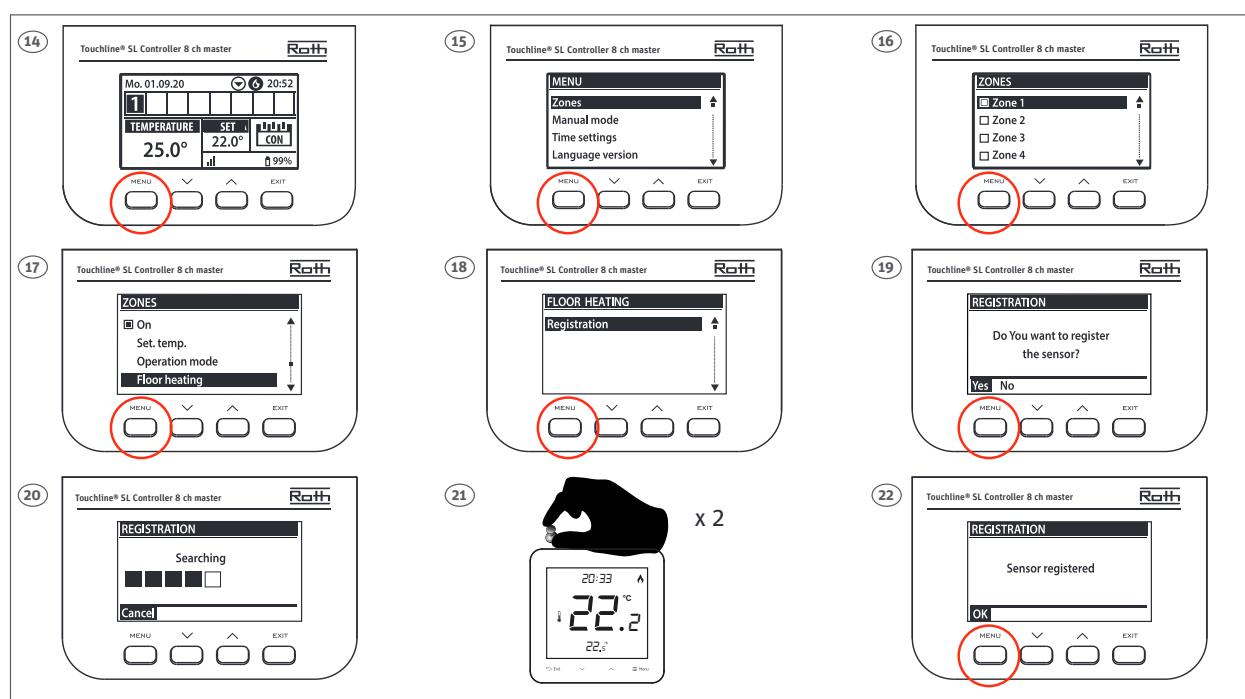
**(DK)** I oversigten på kontrollenheden kan du nu aflæse værdierne for både rumtermostaten (indstillet temperatur 22,0° og aktuel 25,0°) og gulvføleren med aktuel temperatur på (21,0°). Gentag step 14 til 21 for alle andre kanaler (2–8) hvor der ønskes tilsluttet en gulvføler.
