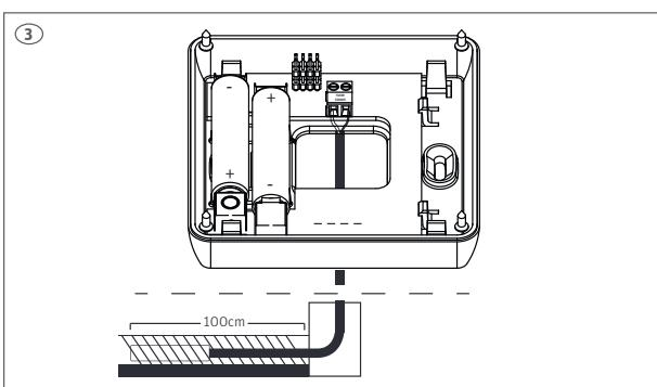
**(DK)** Det er muligt at tilslutte en gulvføler til termostaten (gulvføler ikke inkl.). Tryk forsigtigt ledningerne ind i klemmen og skru dem fast. Føleren skal trækkes i trækrør og følerenden placeres lige under øverste gulvbelægning, midt imellem gulvvarmeslangerne.
