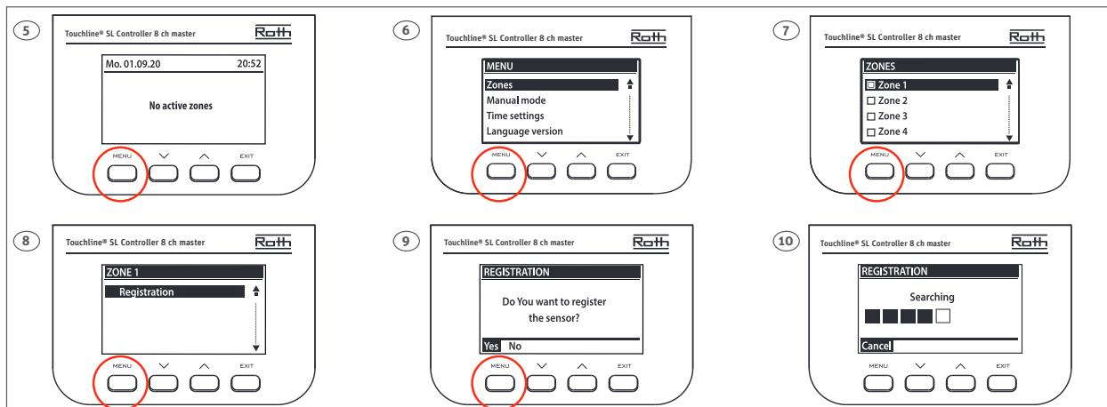
**(DK)** Tilmeld en rumtermostat til en kanal på kontrollenheden. Følg trin 5 til 10 og tryk på tilmeldingsknappen vist som trin 11. Afslut med tryk på Menu og derefter tryk flere gange på Exit indtil standardvisning. Alle el-fordelbinder til pumpe, termomotorer og evt. relæ skal udføres inden der sættes 230V til kontrollenheden, se monteringsvejledningen for dette.
